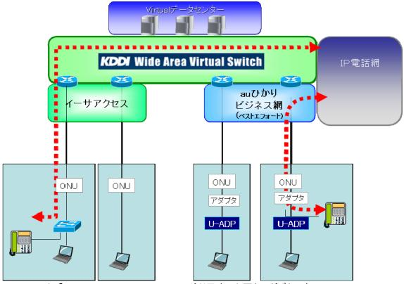
※U-ADP は、「KDDI Wide Area Virtual Switch」ご利用時に必要なアダプタです。 KDDI では音声用のアダプタとセットで提供します。
