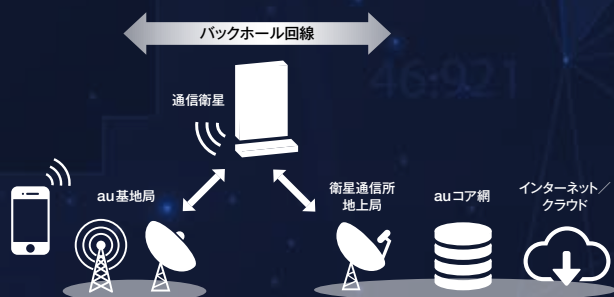
KDDI山口衛星通信所に、Starlinkの通信衛星と地上のインターネット網を接続する地上局を構築
