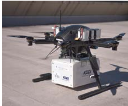
モバイル通信でつながるスマートドローン（実証で使用した機体）
