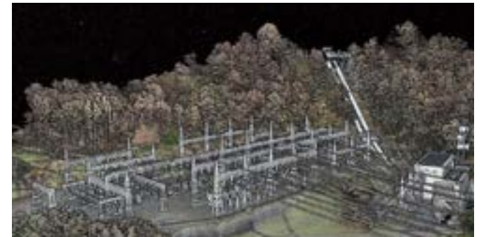
ドローンで撮影したデータから三次元モデル化した例：糠平発電所
