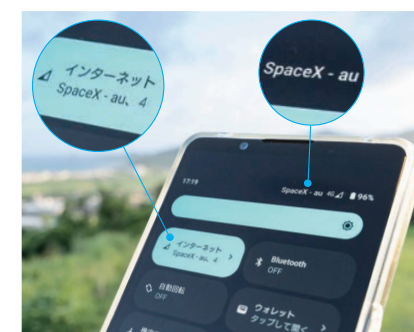
▲直接通信に成功し「SpaceX-au」を示した画面
