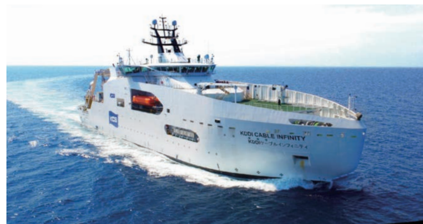
▲船舶型基地局の機能を有するKDDIケーブルインフィニティ
