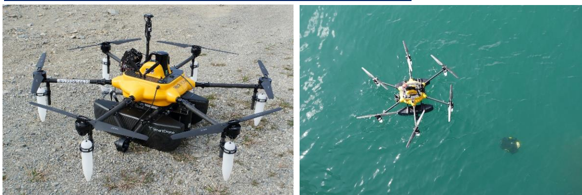
図 19 本機体（左） 親機から分離した子機が潜行する様子（右）
