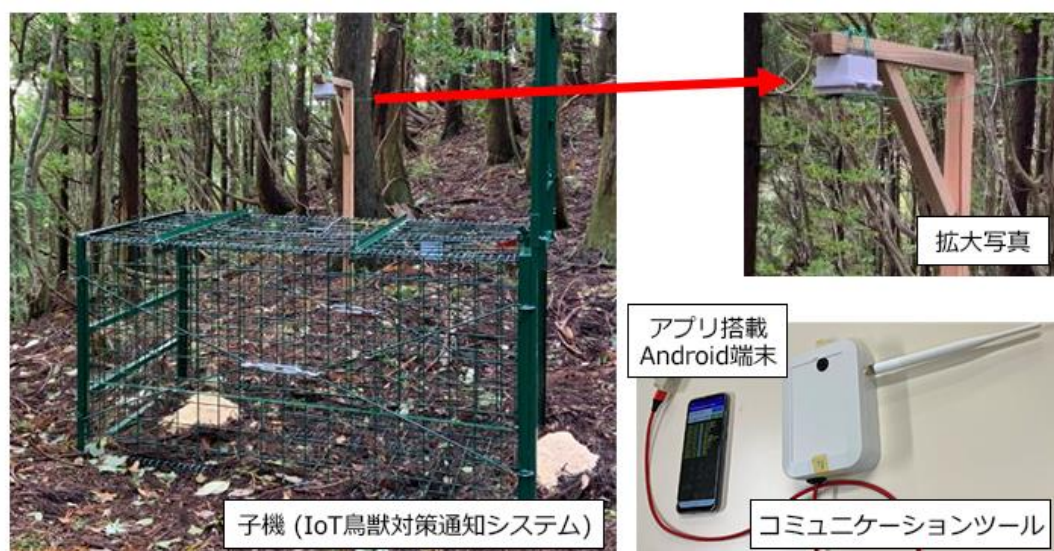
図 27 IoT 鳥獣対策通知システム
