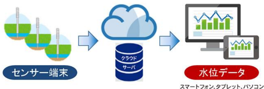
図 25 水田センサーの概要
