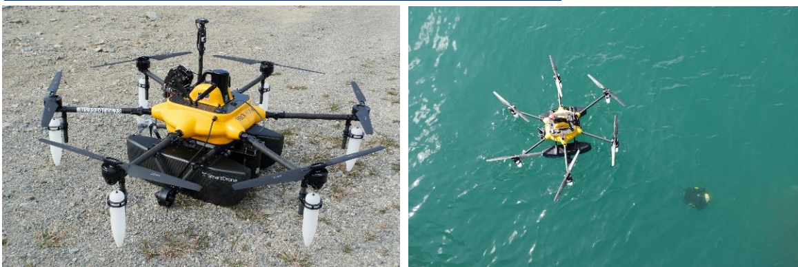
図 18 本機体（左） 親機から分離した子機が潜行する様子（右）
