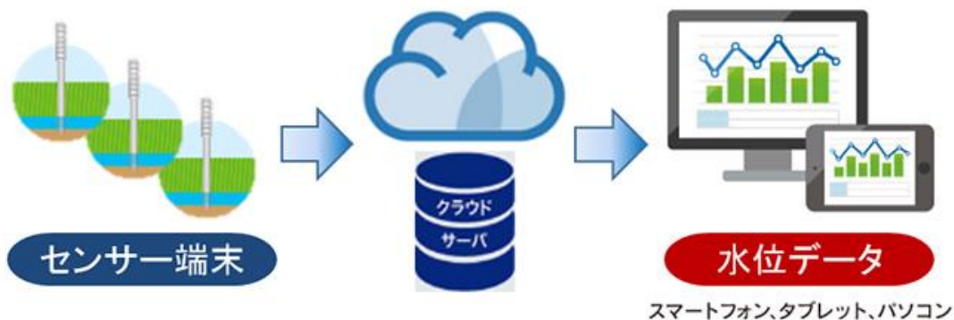
図 24 水田センサーの概要
