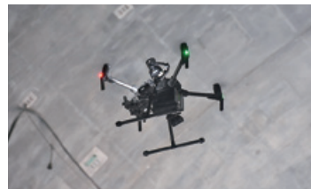
<調査用ドローンによる点検撮影>
